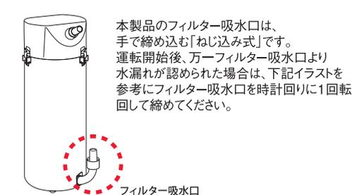
● 固いと感じたら、無理に動かさず、反時計回りに戻してください。フィルターケースの破損につながります。
