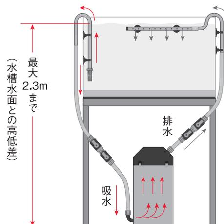
本製品はサイフォンの原理を利用して飼育水を循環させます。本製品は、水槽より下に設置してください。
