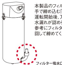
本製品のフィルター吸水口は、手で締め込む「ねじ込み式」です。
