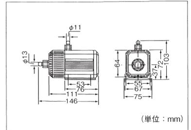
ポンプ性能とは、モーター部分を単独運転させたときの理論上の最大流量を示します。使用環境により実際の流量とは異なります。
