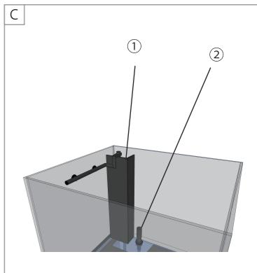
※本製品の排水ストレーナーは、水槽の底部に設けられています。水槽に水が入った状態（②のストレーナーよりも水位が高い場合）で外部式フィルターとのホース接続を外すと、水槽の水が流出しますのでご注意ください。
