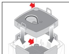
フィルターケースに粗目フィルターパッド(ブルー)を入れたプレフィルターコンテナを入れます。このとき、プレフィルターコンテナと吸水サポート部がしっかり接続(赤矢印部分)されているか確認してください。
