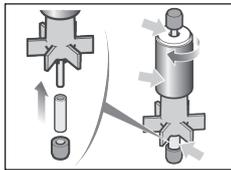
6 インペラーを分解して掃除した場合、スピンドルおよびスピンドルラバーを元通りにセットした後、マグネット部分を左右に回してスムーズに動くことを確認してください。
