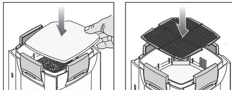
最上段のろ材コンテナの上に細目フィルターパッドを敷き、その上にろ材固定盤を載せます。その際、ろ材コンテナの取っ手がきっちり収納されていることを確認してください。
