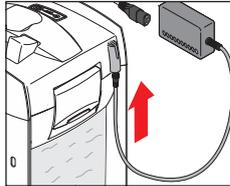
①フィルターケース内が満水になっていることを確認し、電源アダプターのDCプラグをモーターヘッドの受け口に差し込みます。この時点では電源コードと電源アダプターは接続していない状態です。
