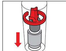
4 洗浄が終わったブラケットに黒いラバーをしっかり取り付け、フロートとともに元の位置にセットします。必ず排水側にセットしてください。
