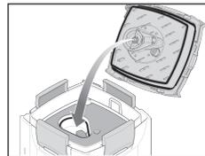
⑨ フィルターケースにモーターヘッドを装着します。セットの手順、点検・お手入れ～⑦モーターヘッドの装着を参照してください。
