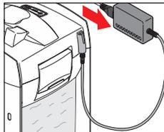
②電源アダプターと電源コードを接続します。この時点では電源プラグをコンセントに差し込まないでください。
