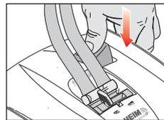
⑩ ホースアダプターを取り付け（ホースアダプターのセットを参照）、呼び水レバーをおして水を呼びこみます。
