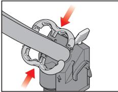
ホースアダプターに取り付けたホースの付け根の部分に、ホースクランプをしっかりと確実に固定します。
