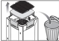
③ プレフィルターコンテナおよびろ材コンテナを全て取り出します。最上段のろ材コンテナ内に使用している細目フィルターパッドは、もみ洗いなどの洗浄をおこなうとへたりなどの劣化を早めることになるため、洗浄をおこなわず、定期交換する必要があります。
