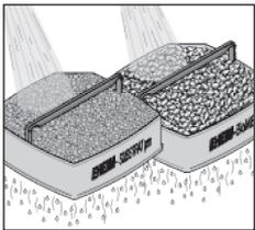
⑤ ろ材を飼育水で軽く洗います。水道水を使用する場合は、バクテリアが死滅する恐れがあるため、予めカルキを抜き、飼育水と温度をあわせた水を使用してください。
