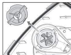
③ ポンプカバーを左（反時計回り）に回して取り外します。
