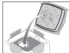
5 フィルターケースにモーターヘッドを装着します。P11の⑦モーターヘッドの装着を参照してください。
