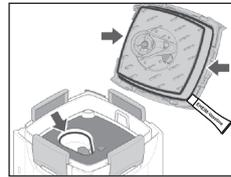
⑧ プレフィルターOリング、プレフィルターケースOリングやOリングを収めた溝に汚れなどが付着している場合は、きれいに掃除をしてエーハイムワセリンを塗布してください。
