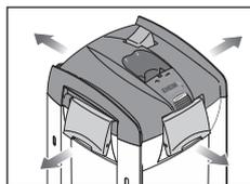
2 シャットオフレバーをOFF側にいっぱいまで傾け、レッドセーフティキャッチを押し込んでホースアダプターを取り出します。その後、EZクリップを解除してモーターヘッドを取り外します。
