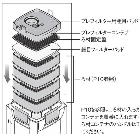
P10を参照に、ろ材の入ったろ材コンテナを順番に入れます。ろ材コンテナのハンドルは下ろしてください。
