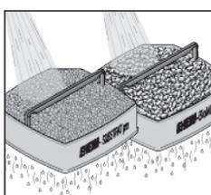
ろ材コンテナにろ材(P10参照)を入れ、流水で濁り水が出なくなるまで十分に洗浄します。
