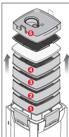
フィルターケースの中から、プレフィルターコンテナ、ろ材固定盤、ろ材コンテナを全部取り出します。
