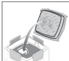
フィルターケースにモーターヘッドを装着します。この際、Oリングにねじれがないか、異物がひっかかったり挟まったりしていないかなど、しっかり確認してください。その後、モーターヘッドとフィルターケースがしっかり密着していることを確認してからEZクリップで確実にロックしてください。
