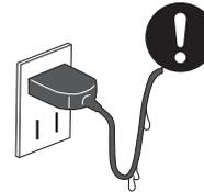
電源コードに水が伝わってしまった場合は、電源プラグを抜かず、直ちに元電源のブレーカーを遮断したあと、電源プラグを抜いて、状況を確認してください。
