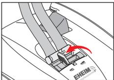
ホースアダプターのシャットオフレバーを「ON」の方向にいっぱいまで傾けます。これでホースアダプターがモーターヘッドにロックされると同時に、吸水口と排水口が完全に開放されます。シャットオフレバーが「ON」の位置に移動しない場合は無理をせず、ホースアダプターを外し、もう一度装着し直してください。
