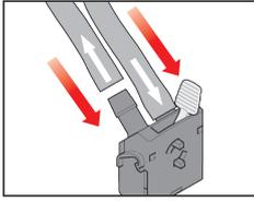
本体正面（ホースアダプターをモーターヘッドにセットした状態）から見て、向かって右側に吸水、左側に排水、それぞれのホースを根元までしっかりと取り付けます。イラストのホースの中の矢印は水流の向きを示し、赤い矢印はホースをホースアダプターに取り付けることを示しています。この作業は、モーターヘッドからホースアダプターを取り出した状態でおこなうことも可能です。ホースをホースアダプターに取り付ける際は、くれぐれも吸水側、排水側の取り付け間違いにご注意ください。
