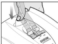
⑥ ホースアダプターを取り付け(ホースアダプターのセットを参照)、呼び水レバーをおして水を呼びこみます。
