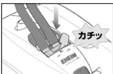
ホースアダプターをモーターヘッドに装着する際は、ゆっくりと押し込んでいき、「カチッ」と音がするまで確実にはめ込みます。このとき、シャットオフレバーは必ず「OFF」の位置にしてください。また、レッドセーフティキャッチにはさわらないでください。
