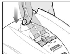
⑩ ホースアダプターを取り付け（ホースアダプターのセットを参照）、呼び水レバーをおして水を呼びこみます。
