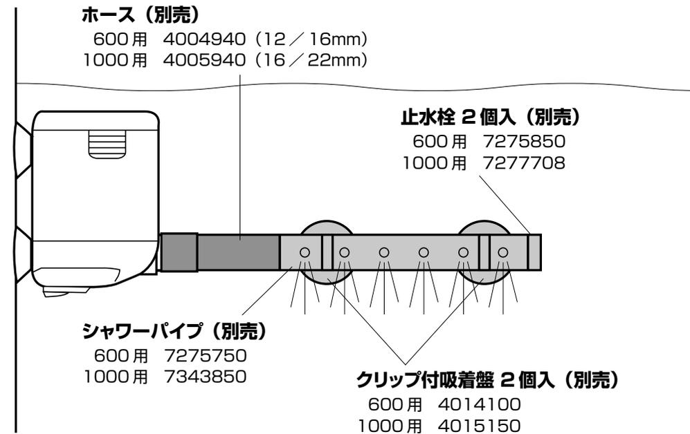
エーハイムホースを接続用に適当な長さにカットして、シャワーパイプを取り付けて下さい。シャワーパイプをセットする場合、止水栓とクリップ付吸着盤をご使用下さい。
