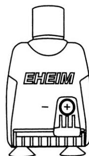
左図の矢印部分の流量調整つまみにより、吐出水量を調整することができます。
