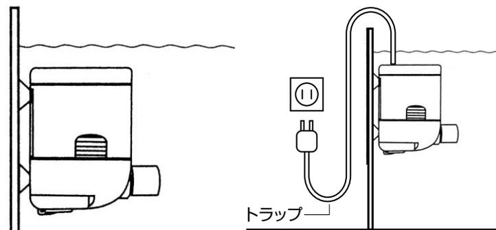
水中のお好きな場所にセットして下さい。水槽のかべ(ガラス)に取り付ける時は、付属のキスゴムでしっかり取り付けて下さい。また、底砂などが吸い込まれない場所に取り付けて下さい。水がコードを伝わってコンセントまで来ない様トラップ(左図参照)を設けて下さい。
