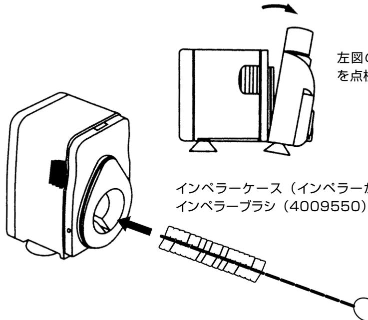
左図の様にポンプカバーを外して内部を点検して下さい。
