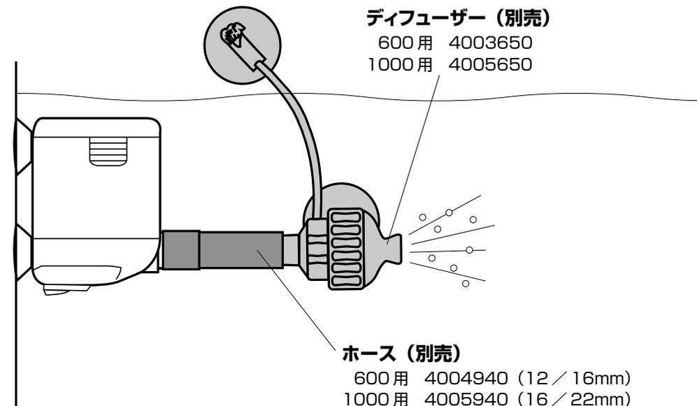
エーハイムホースを接続用に適当な長さにカットして、ディフューザーを取り付けて下さい。流量が少ないとエアを巻き込みませんので、流量調整つまみを「+」方向に合わせて下さい。
