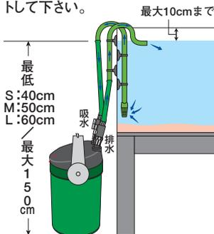
※マルチハンドルによる呼び水機能を確実にするため、水槽上縁から水面までの高低差は、最大で10cmまでとして下さい。
